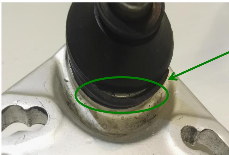
Quando o guarda-pó se rasga, há entrada de impureza. Dessa forma, acaba ocorrendo um atrito entre a esfera do pivô e o polímero que o prende, e o pivô perde o seu ajuste.
