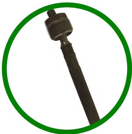
**O que é:** é o componente responsável pela ligação e transferência de movimento entre o mecanismo da caixa de direção e o terminal de direção.
